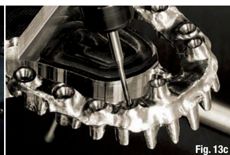
Figs. 13a-c_Usinage dans un disque de titane.
