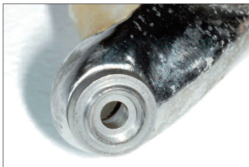
Fig. 27- Préforme titane usinée collée dans l'armature chrome-cobalt.
